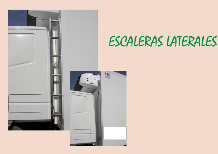
Las escaleras laterales estan construidas por entero en acero inoxidable de gran resistencia, a la corrosion y al uso cotidiano. Son plezables, asi cuando no se tienen que gastar se pueden escamotear lateralmente y quedan escondidas como un simple perfil. Llevan seguro, para que no se abra durante la marcha y existe la opcion de colocarles un ojal y poner de esta manera un dispositivo de bloqueo para evitar la apertura a personal no autorizado.
